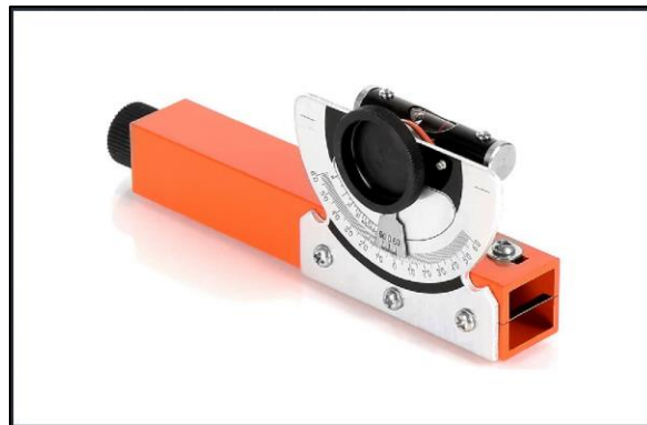
Figura 9. Esquema-Método_Nivel-Abney. Modificado de: asequipos.com.
