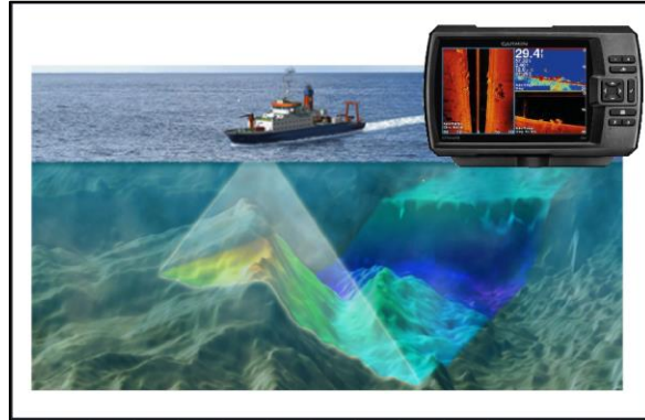
Figura 19. Esquema-Método_Ecosonda. Modificado de: tecnociano.com y nautica.com .
